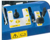
Rotation cheminée électrique
